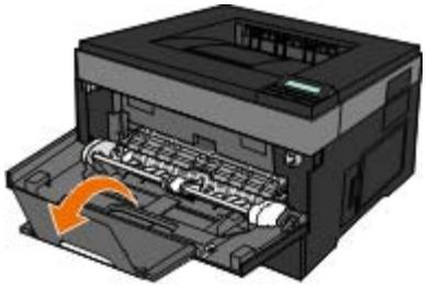
4. Ziehen sie die Erweiterung langsam nach unten, um die Universalzuführung vollständig auszufahren.
