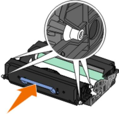
8. Setzen Sie das Fotoleitertrommel-Kit mit der Druckkassetteneinheit in den Drucker ein, indem Sie die blauen Pfeile an den Führungen des Fotoleitertrommel-Kits auf die blauen Pfeile im Drucker ausrichten und die Fotoleitertrommel so weit wie möglich in den Drucker schieben. Das Fotoleitertrommel-Kit *rastet* hörbar ein, wenn es richtig eingesetzt ist.
