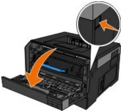
3. Heben Sie die Basis des Fotoleitertrommel-Kits an, ziehen Sie es vorsichtig mit der Druckkassette nach oben und aus dem Drucker heraus.
