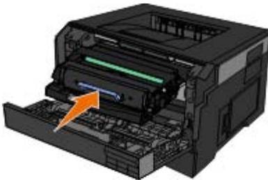
9. Nachdem Sie die Fotoleitertrommel ausgetauscht haben, sollten Sie den Zähler der Fotoleitertrommel zurücksetzen. Die Anleitung zum Zurücksetzen des Zählers finden Sie in dem mit der neuen Fotoleitertrommel gelieferten Anleitungsblatt.
