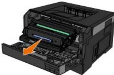
Legen Sie das Fotoleitertrommel-Kit mit der Druckkassetteneinheit auf eine flache, saubere Oberfläche.
