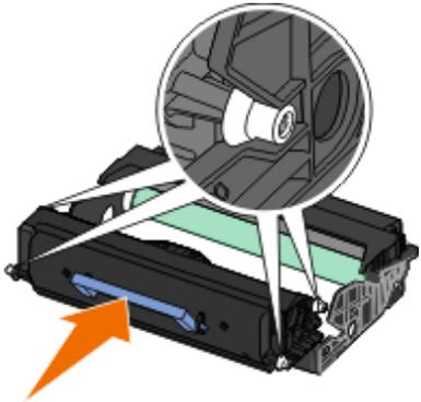
7. Setzen Sie das Fotoleitertrommel-Kit mit der Druckkassetteneinheit in den Drucker ein, indem Sie die blauen Pfeile an den Führungen des Fotoleitertrommel-Kits auf die blauen Pfeile im Drucker ausrichten und die Fotoleitertrommel so weit wie möglich in den Drucker schieben. Das Fotoleitertrommel-Kit *rastet* hörbar ein, wenn es richtig eingesetzt ist.
