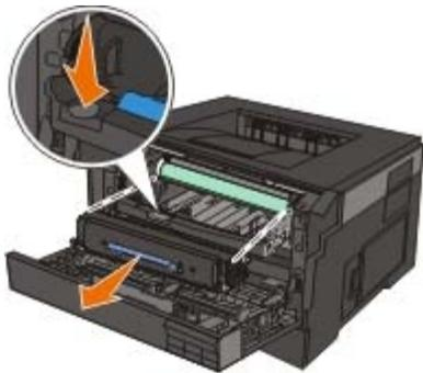
4. Legen Sie die Druckkassetteneinheit auf eine flache, saubere Oberfläche.
